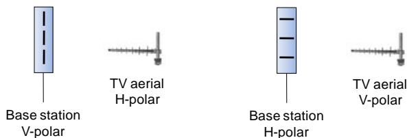
Figure 19. Orthogonal-to-DTT polarisation.
